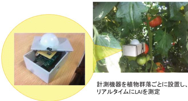
計測機器を植物群落ごとに設置し、リアルタイムにLAIを測定
