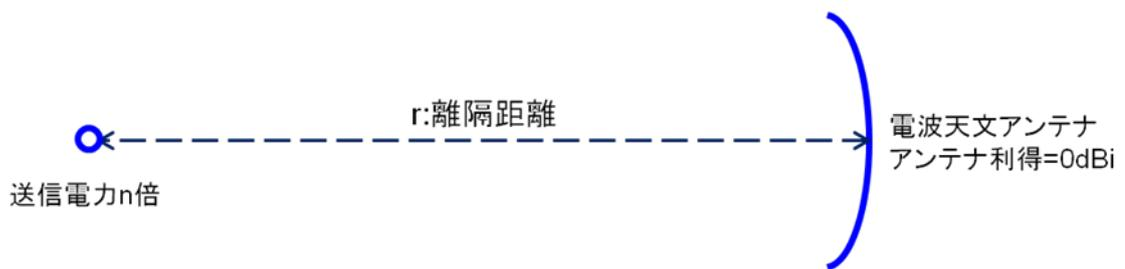
自由空間伝搬では、シングルエントリーの離隔距離  $r_s$  に対してアグリゲートの離隔距離  $r_a$  は  $\sqrt{n}$  倍になる。
