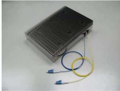
図 6 オンボード型光トランシーバ外観
