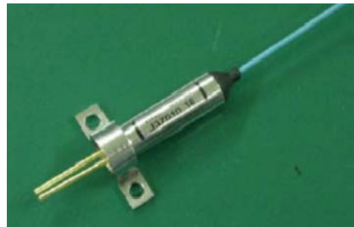
図 3.2.2 非温調型レーザダイオード
