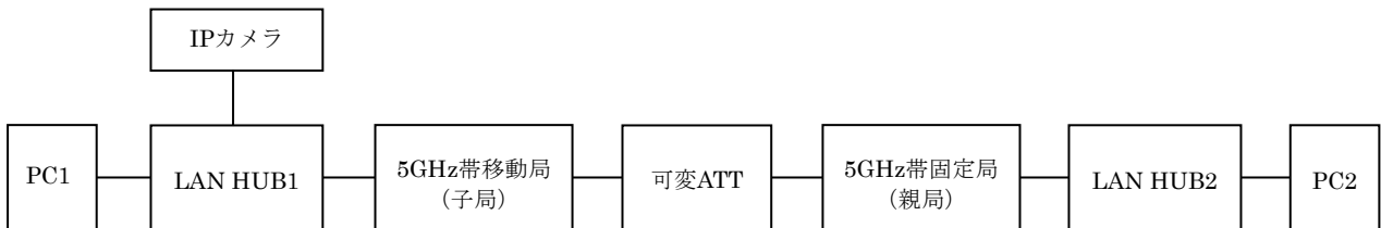
図 3.7.2 Wi-Fi(5GHz 帯)伝送システムの評価系統図
