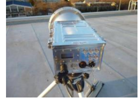
屋上の幹線応急復旧用 23GHz 無線送信機
