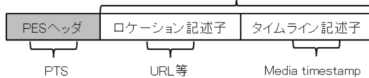
図 3.2.3 タイムライン拡張 PES パケットの構成例
