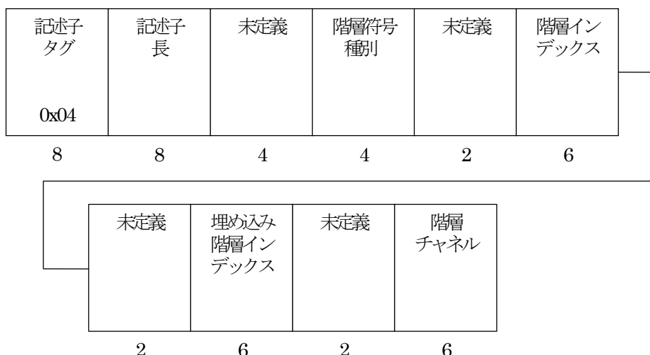
図 2.1 階層符号化記述子のデータ構造
