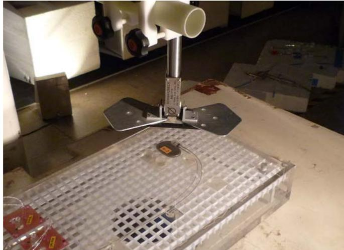
図 2-2 平面型の小型広帯域アンテナの配置状況例
