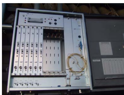
(F) 第1GFのヘッドアンプの内部
