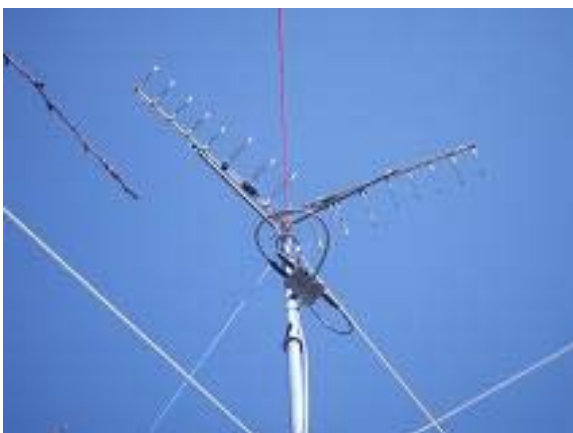
(K) 第1GFの送信アンテナ拡大図 (8素子リングアンテナと電力分配器)
