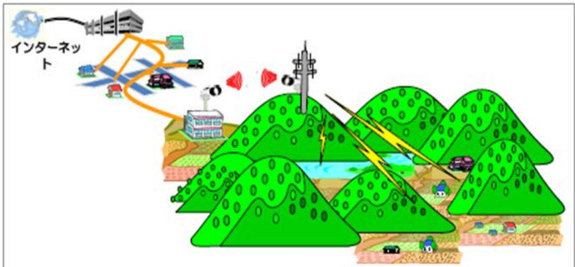
図 1-4 携帯電話等の基地局のエントランス回線としての利用
