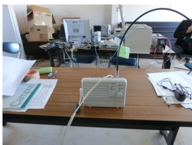
外部アンテナ接続測定状況(16QAM)
