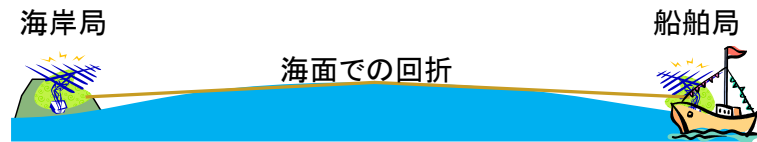
図 3-5 見通し距離外伝搬路:海面回折による回折波
