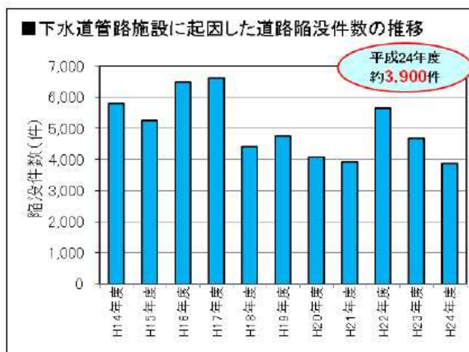
下水道管路施設に起因した道路陥没件数の推移（国土交通省）
