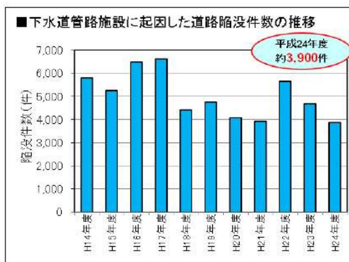
図表 III-6 下水道管路施設に起因した道路陥没件数の推移（国土交通省）
