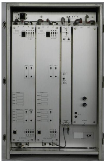
装置寸法：640mm(H)×400mm(W)×220mm(D) 質量：約 23kg 消費電力：約 95W 研究試作品 ( B S )
