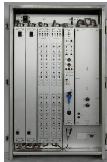
装置寸法：640mm(H)×400mm(W)×220mm(D) 質量：約 27kg 消費電力：約 110W 研究試作品 (地デジ)
