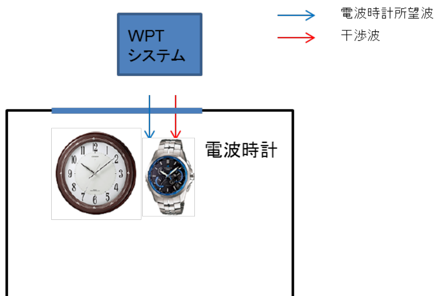
図 4.3.2.1-1 電気自動車用 WPT と電波時計の干渉検討モデル
