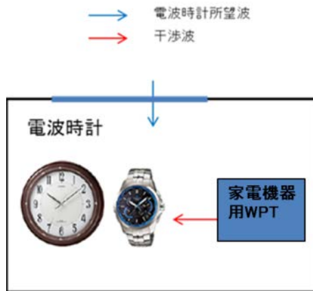
図 3. 2. 2-1 WPT システムの設置モデル (同一家屋)
