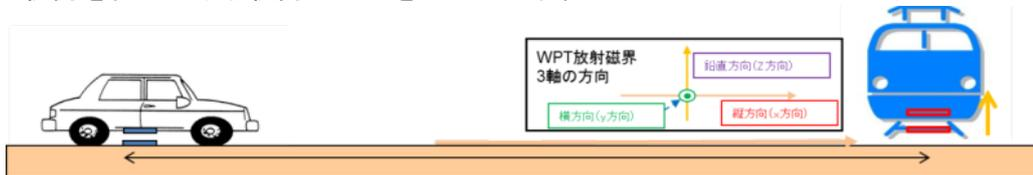
図 3. 3. 1-3 電気自動車用 WPT と信号保安設備の干渉検討モデル 1
