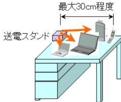
図 2.3-5 利用形態(2):送電スタンドの周囲のモバイル機器への電力伝送
