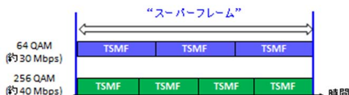
図： 2つの搬送波で約70MbpsのTSを分割伝送し、受信機で合成する例
