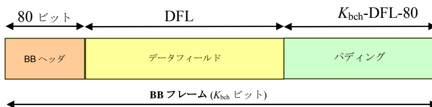
図 3.3-10 ストリームアダプタ出力に於けるBBフレームの形式
