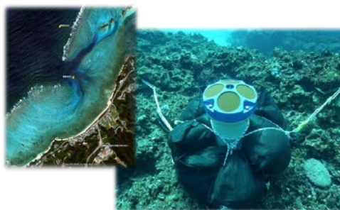
図 1 流速計の設置場所と設置方法 海底にくい打ちしてフレームを固定し、さらに土嚢袋をのせて厳重に固定する。
