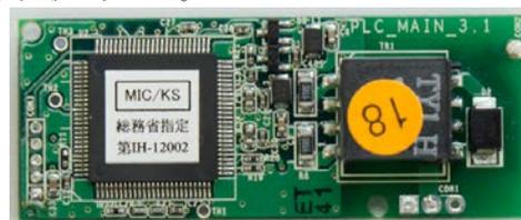
図 1 低速型 PLC 通信モジュール
