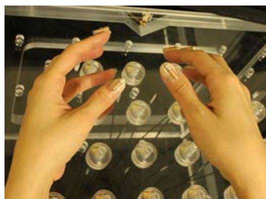
(b) 各指先に付けた 10 個の LC 共振型磁気マーカ 図 1: 開発した非接触・非拘束・小型 3D センサ
