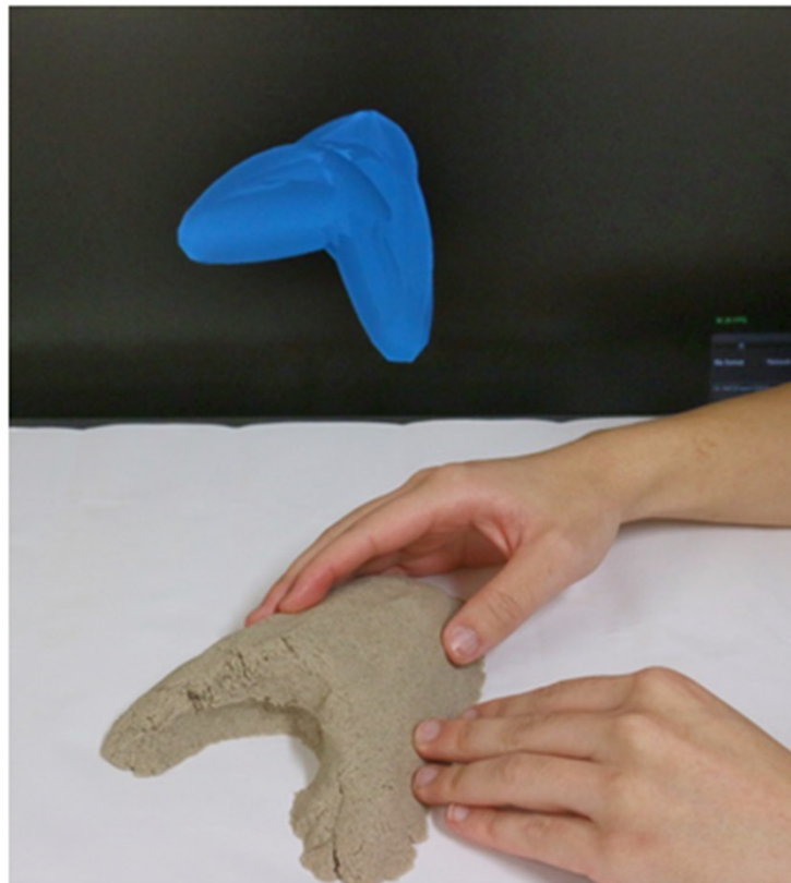
開発した3Dセンサを埋め込んだ 粘土の実時間3D形状計測 (フィジカル3Dインタラクション)
