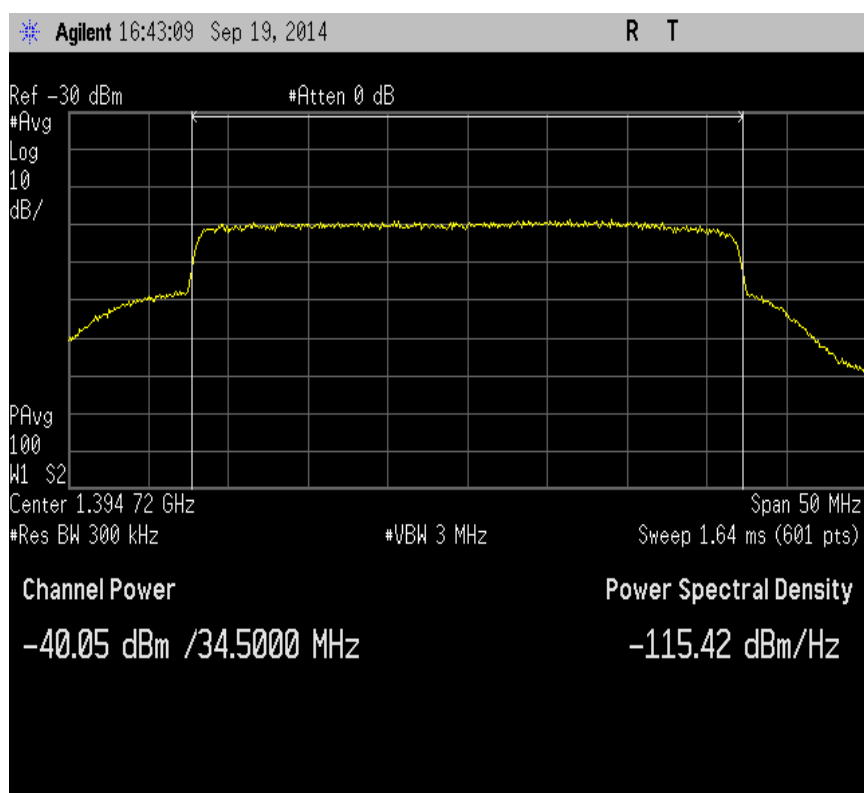
写 2.1-4 変調器 2 : 16APSK(7/9) OBO=2.2dB 測定チャンネル周波数 BS-19ch(1394.72MHz)
