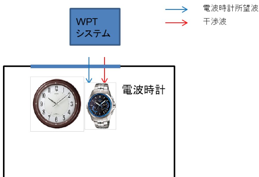
図 3.2.1-1 電気自動車用 WPT と電波時計の干渉検討モデル
