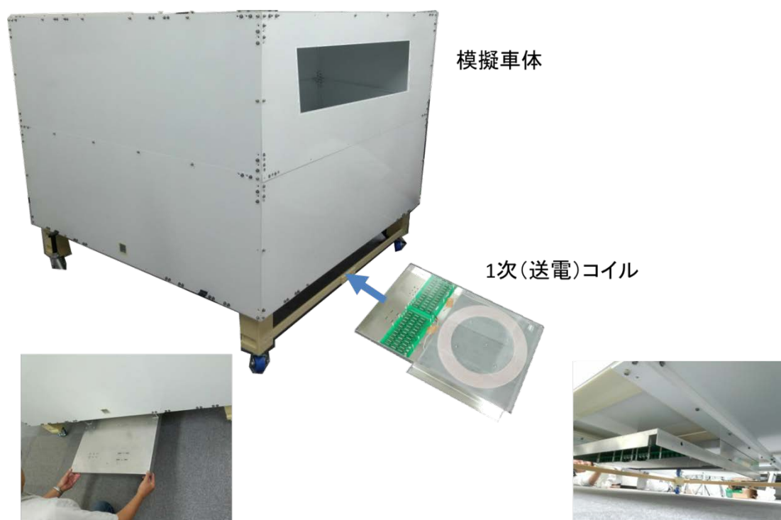
図 A. 4-1 試験装置①（電気自動車用）
