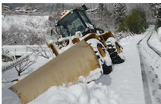
除雪車の転倒
