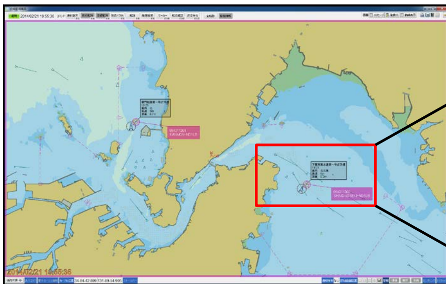
AIS対応電子海図装置による AIS搭載船舶及び航路標識AISの表示画面 (例)
