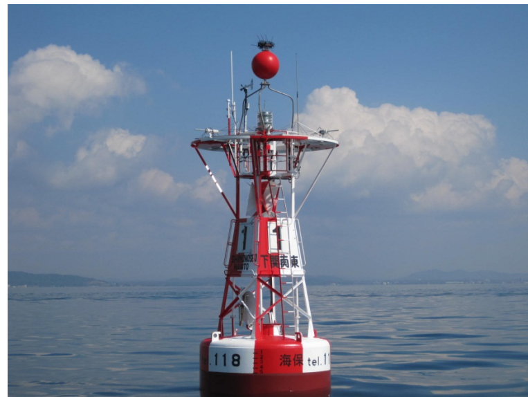
航路標識AISを搭載したブイ (実験試験局) (下関南東水道第1号灯浮標(安全水域標識))
