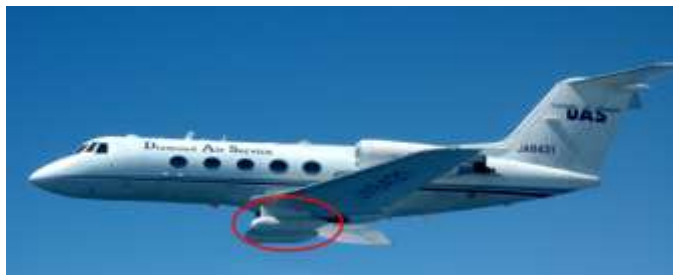
ガルフストリーム機に搭載された“Pi-SAR2” 両翼の付根に設置された2つのアンテナポットに、 送信用のアンテナと受信用のアンテナが格納されて います(赤線枠内)。
