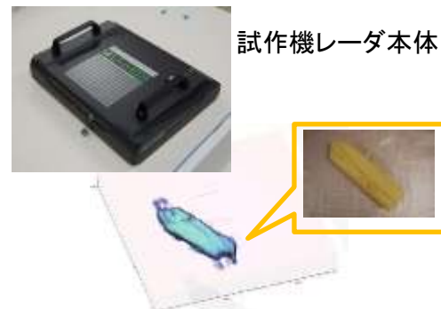
3次元出力例(ターゲット;木材) 設置場所;石膏ボード背面80mm
