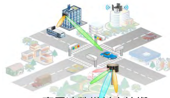
高周波数帯対応技術 (Massive MIMO技術)
