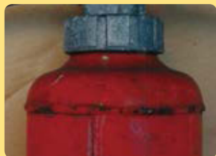
長い間放置され 腐食の進んだ 消火器
