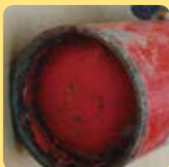
長い間放置され 腐食の進んだ 消火器
