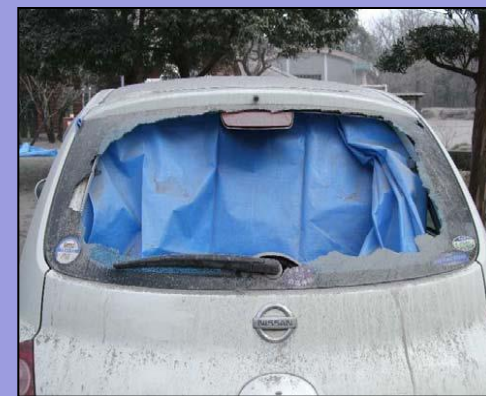
直径4~6cmの小さな噴石により車のリアガラス破損(火口から約7km) (霧島山新燃岳2011年噴火)
