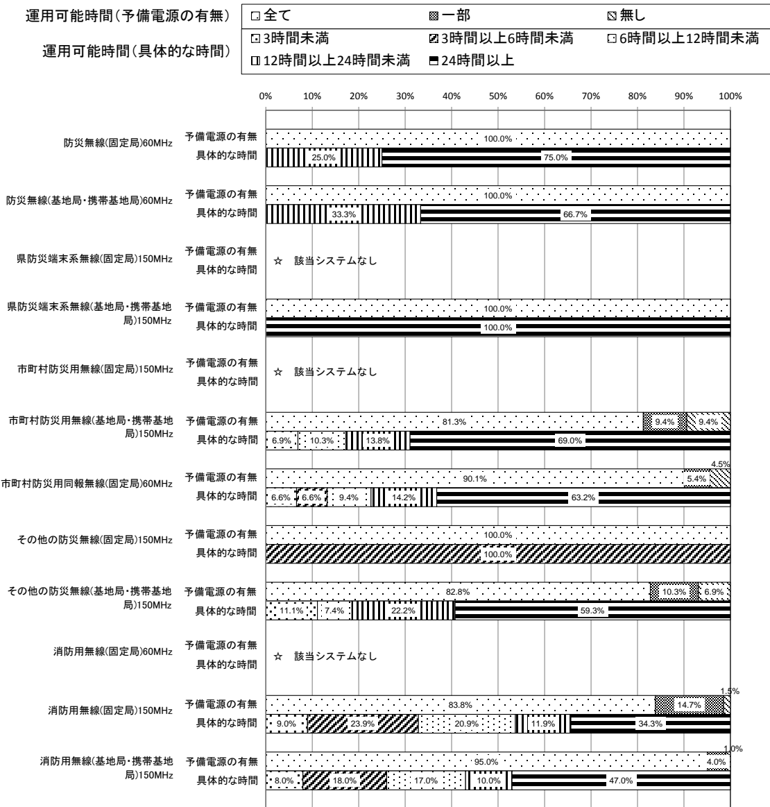
図表一海-4-14 予備電源保有状況及び予備電源の最大運用可能時間 (防災端末系無線・県防災端末系無線・市町村防災用無線・その他防災無線・消防用無線)(内訳) 【東海】
