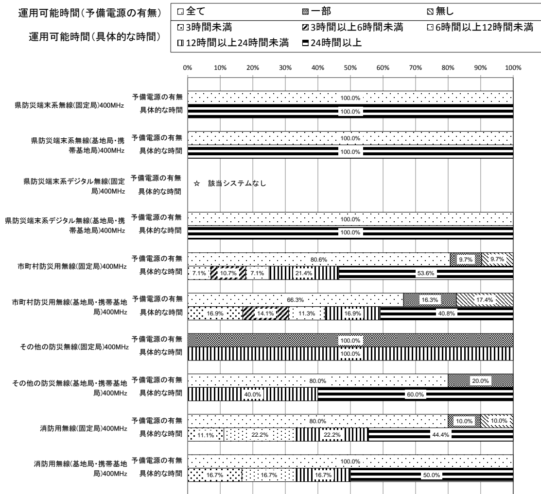
図表一近一6一13 予備電源保有状況及び予備電源の最大運用可能時間 (県防災端末系無線・県防災端末系デジタル無線・市町村防災用無線・消防用無線)(内訳) 【近畿】
