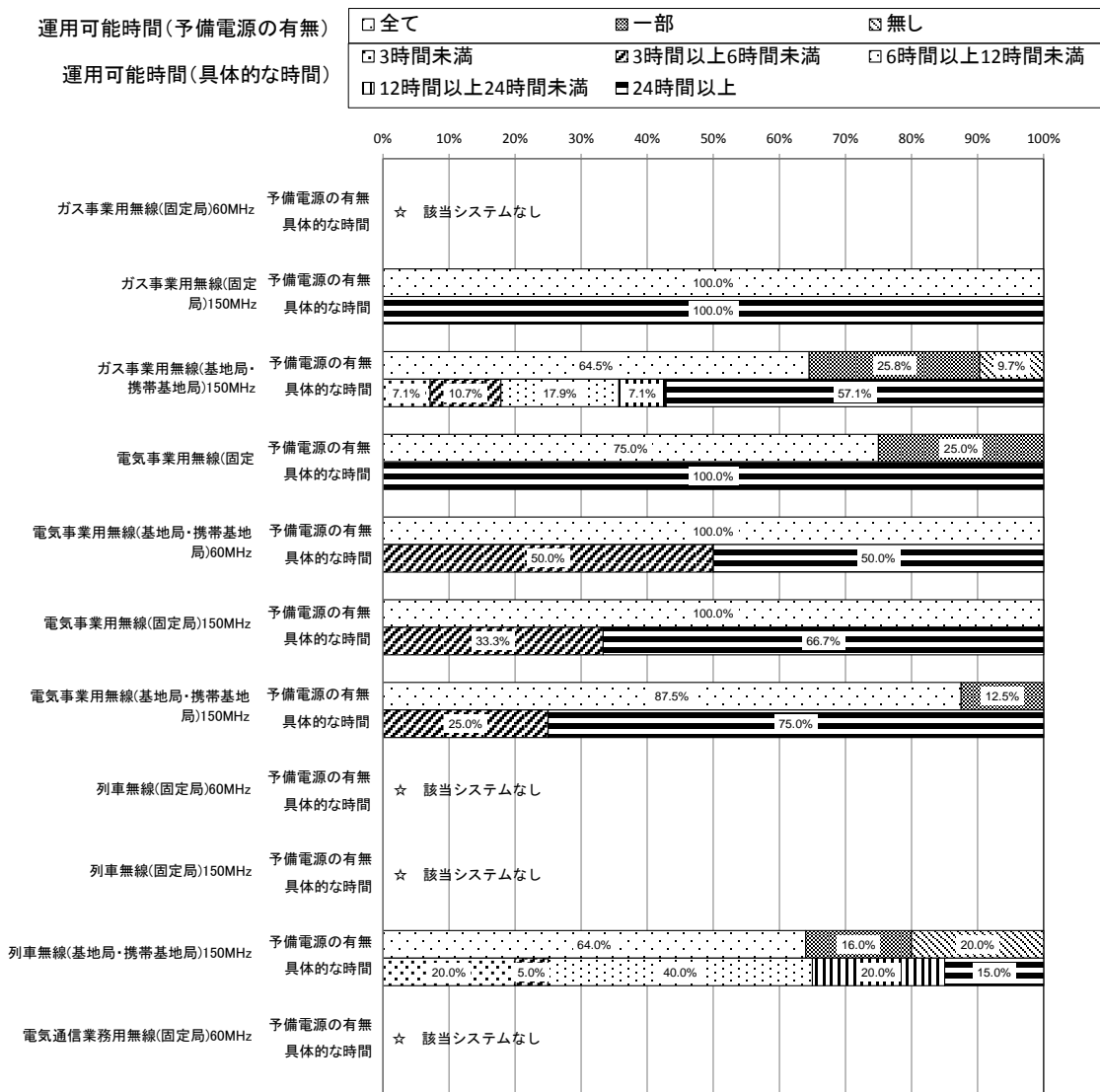
図表一東-4-16 予備電源保有状況及び予備電源の最大運用可能時間 (ガス事業用無線・電気事業用無線・列車無線・電気通信業務用無線)(内訳)【東北】
