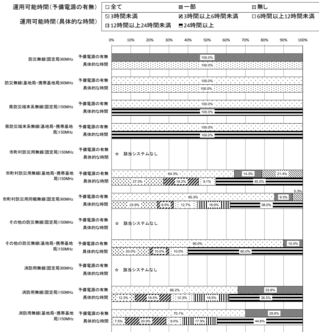
図表一北-4-1-4 予備電源保有状況及び予備電源の最大運用可能時間 (防災端末系無線・県防災端末系無線・市町村防災用無線・その他防災無線・消防用無線)(内訳)【北海道】
