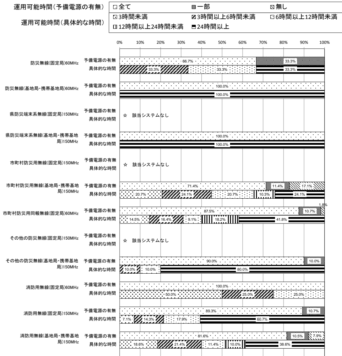
図表一信一4-14 予備電源保有状況及び予備電源の最大運用可能時間 (防災端末系無線・県防災端末系無線・市町村防災用無線・その他防災無線・消防用無線)(内訳) 【信越】
