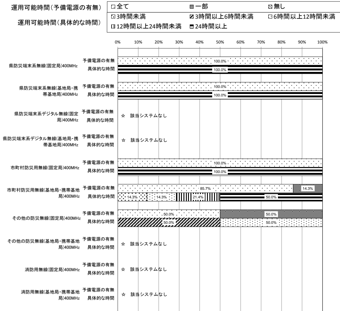
図表一沖一六一三 予備電源保有状況及び予備電源の最大運用可能時間 (県防災端末系無線・県防災端末系デジタル無線・市町村防災用無線・消防用無線) (内訳) 【沖縄】
