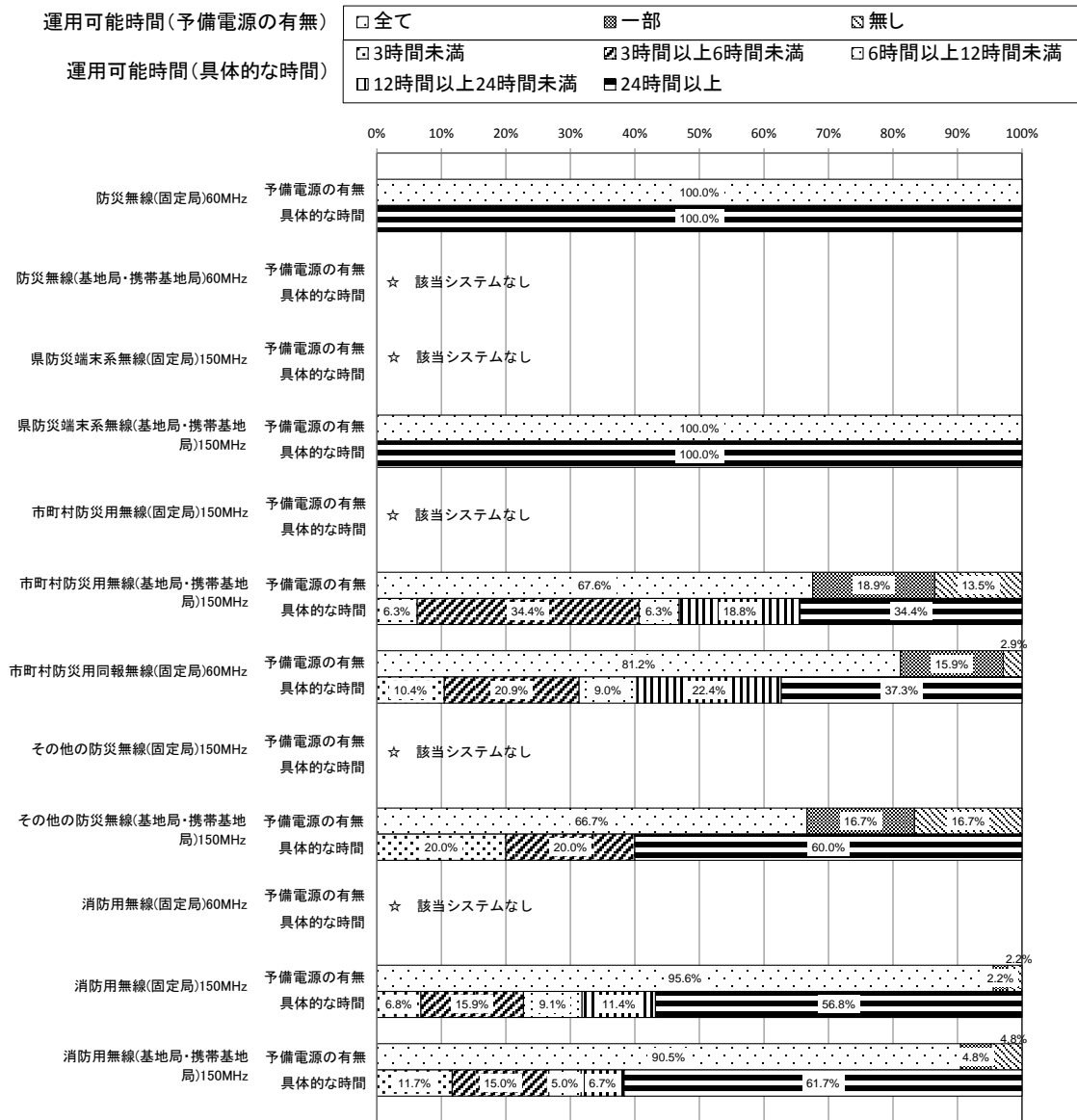
図表一中-4-14 予備電源保有状況及び予備電源の最大運用可能時間 (防災端末系無線・県防災端末系無線・市町村防災用無線・その他防災無線・消防用無線)(内訳) 【中国】
