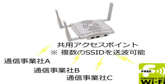
図表・42 Fukuoka City Wi-Fi の既設 AP 共用の例
