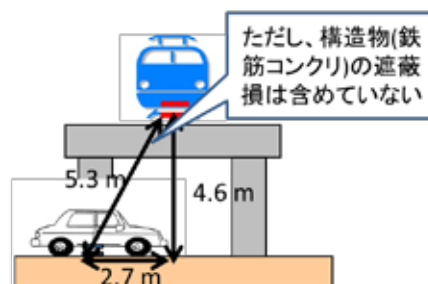
図 3.3.1-18 モデル 3 の場合の所要離隔距離の関係図
