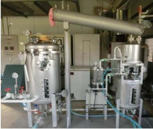
アロマ減圧水蒸気蒸留装置
