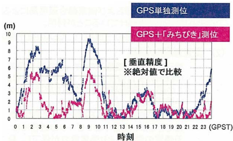
図 4-2 GPS のみによる測位とみちびきを加えた場合の測位精度の比較
