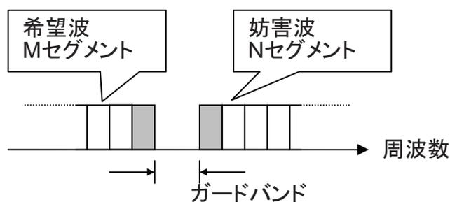
図3.3.8.4-5 希望波と妨害波の配置図
