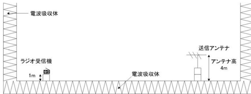
図 1(a) 電波暗室における送信アンテナとラジオ受信機の位置関係 (側面図)
