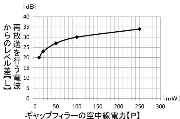
図14 空中線電力と隣接レベル
