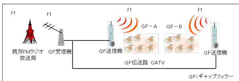
図 6 CATV網（ダークファイバー）を使用し
