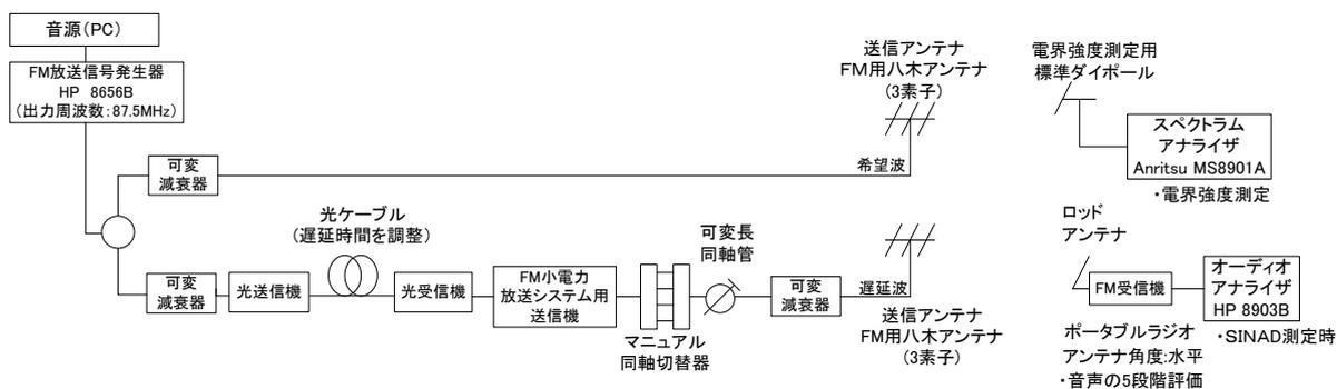
図 2 測定系統図
