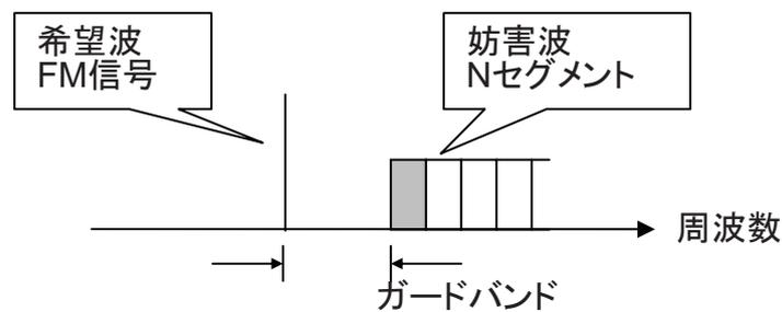
図3.3.8.4-2 希望波と妨害波の配置図
