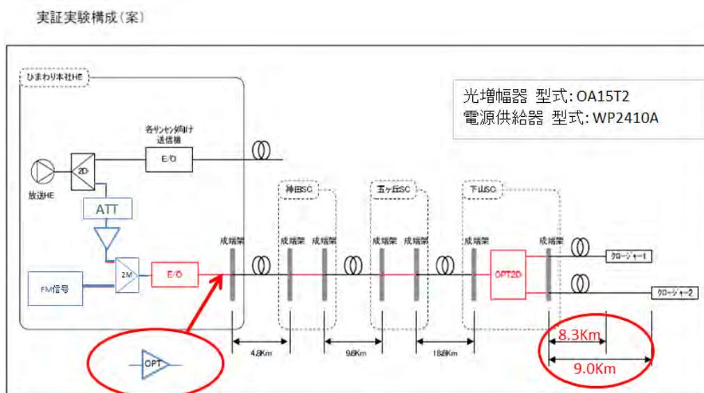
図5 送信点1と送信点2のクロージャーマでの光ケーブル長
