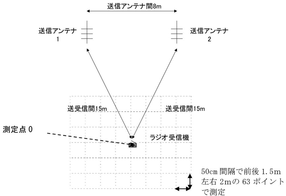
図 1(b) 電波暗室における送信アンテナとラジオ受信機の位置関係 (平面図)
