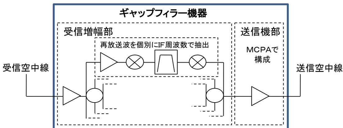
図15 ギャップフィルターの概略構成
