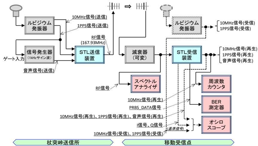
図3 試験における機器構成
