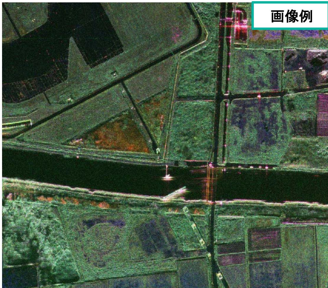
研究開発中の航空機搭載SARで取得したSAR画像 (2014年9月観測・仙台空港近辺: R(HH), G(HV), B(VV))
