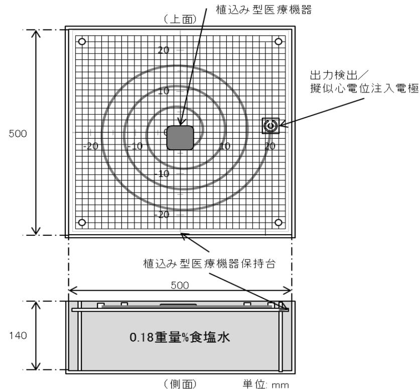
図-3 植込み型医療機器の測定に用いた人体ファントムの構成と配置
