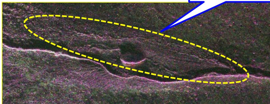
噴煙/水蒸気を透過し、火口の状況を確認可能
