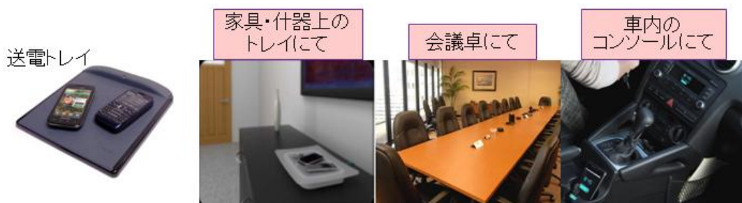
図 2.3-2 利用形態(1):送電台上に置いたモバイル機器への電力伝送
