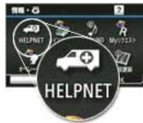
事故や急病時、ヘルプネットボタンにタッチするだけで、ヘルプネットセンターへ接続。自動で送信された車両位置に基づいて、専門のオペレーターが速やかに所轄の警察や消防に回線を接続します。
