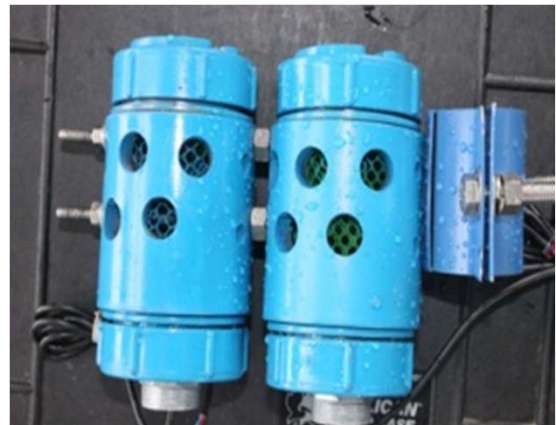
ウェットセンサーおよびドライセンサー。ウェットセンサーは10m、5m、1mといった標高別に設置され、ドライセンサーは干潮位より1m下方に設置される。
