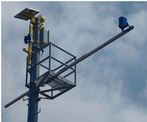
潮位変動を連続的に観測するための超音波式潮位計
