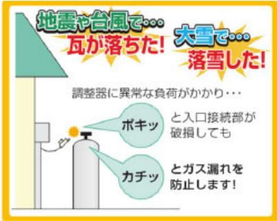
●落雪等で調整器に異常な負荷が加わると左図のように入口接続部が折れてボールが栓をしてLPガスの流出を防止する機構が付いています。
