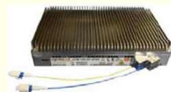
図. 従来の100G光インタフェースの例
