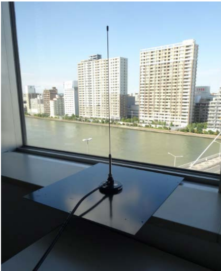
[1-3] 東京都中央区日本橋 ビル8Fの窓際 λ/4 ホイップアンテナ -113.1dBm
