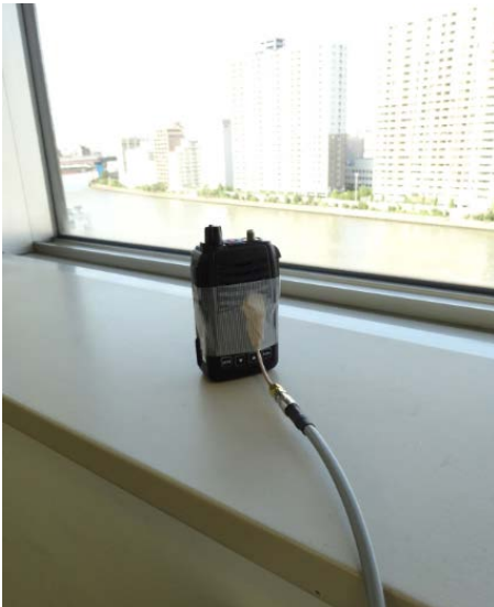
[1-2] 東京都中央区日本橋 ビル8Fの窓際 携帯機 ANT 無し -117.1dBm
