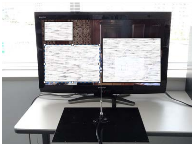
[3-2] テレビの近く 30cm (電源 ON) \lambda/4 ホイップアンテナ -101.2dBm
