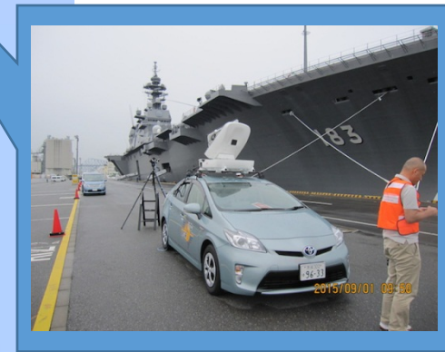
自動捕捉型車載局(日本無線製)
