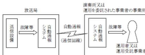
C 無人運用時放送設備の損壊等を運用者の携帯端末にメールで自動通報するシステムを設ける措置
