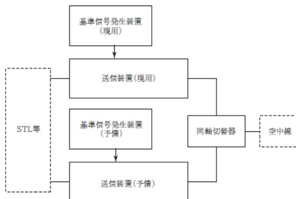
(イ) 送信装置を並列合成方式とする装置（第3図参照）
