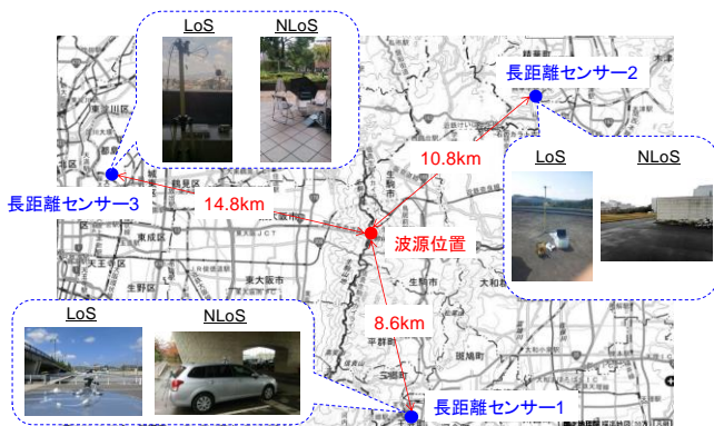
図 2 波源位置推定実験センサー配置位置
